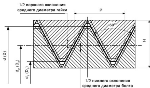
Рис. 13. Параметры метрической резьбы
