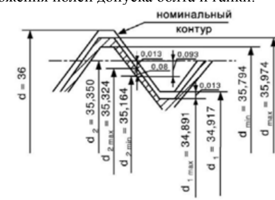
Рис. 14. Схема расположения полей допуска болта.
